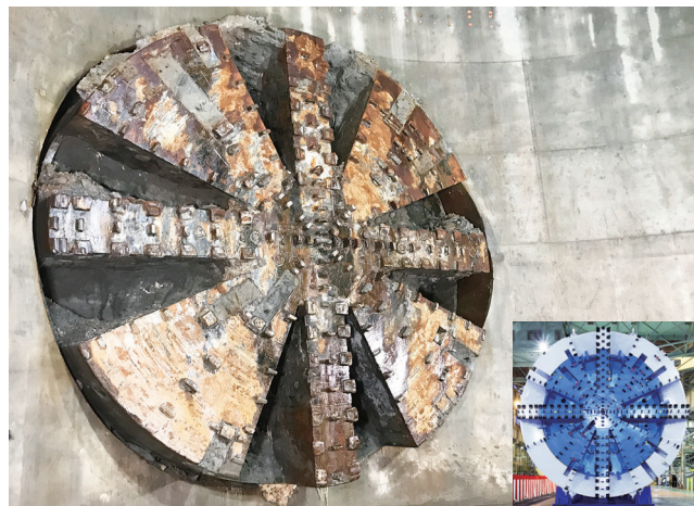
写真-1 子機（φ5,340mm）到達状況
